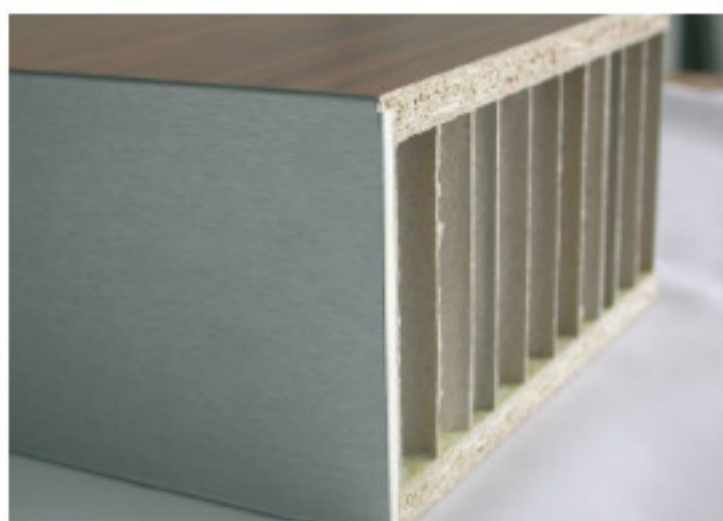
Structure d'un panneau alvéolé avec chant d'apprêt
